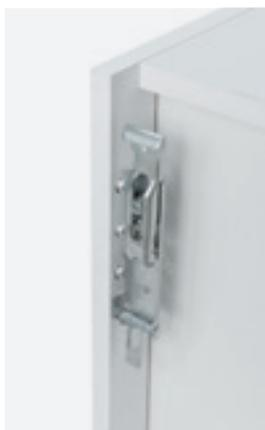
Colgador oculto "Traser 6" para los módulos altos que permite una regulación total de los mismos en altura como en profundidad.
